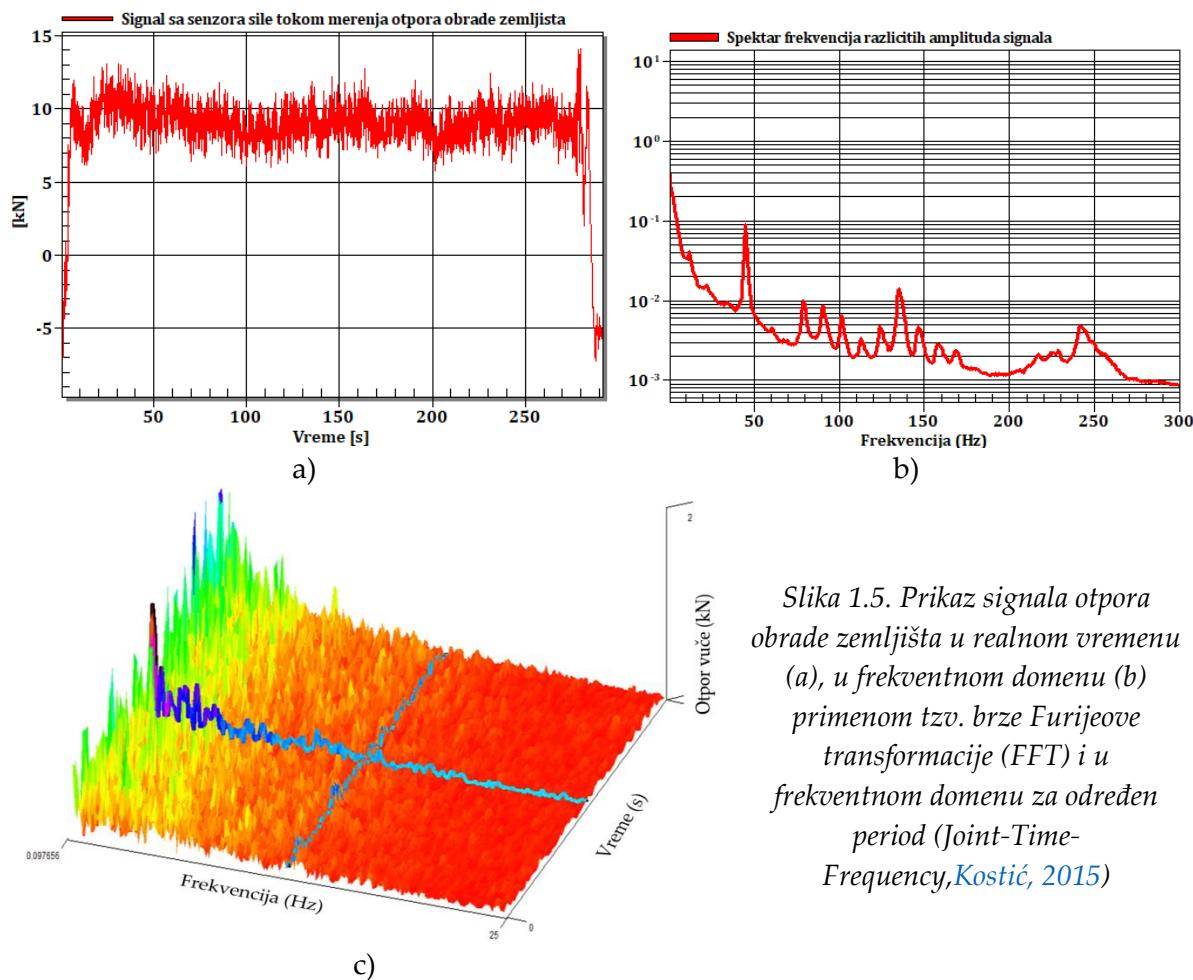
*Slika 1.5. Prikaz signala otpora obrade zemljišta u realnom vremenu (a), u frekventnom domenu (b) i u vremensko-frekventnom domenu za određen period (Joint-Time-Frequency, Kostić, 2015)*
