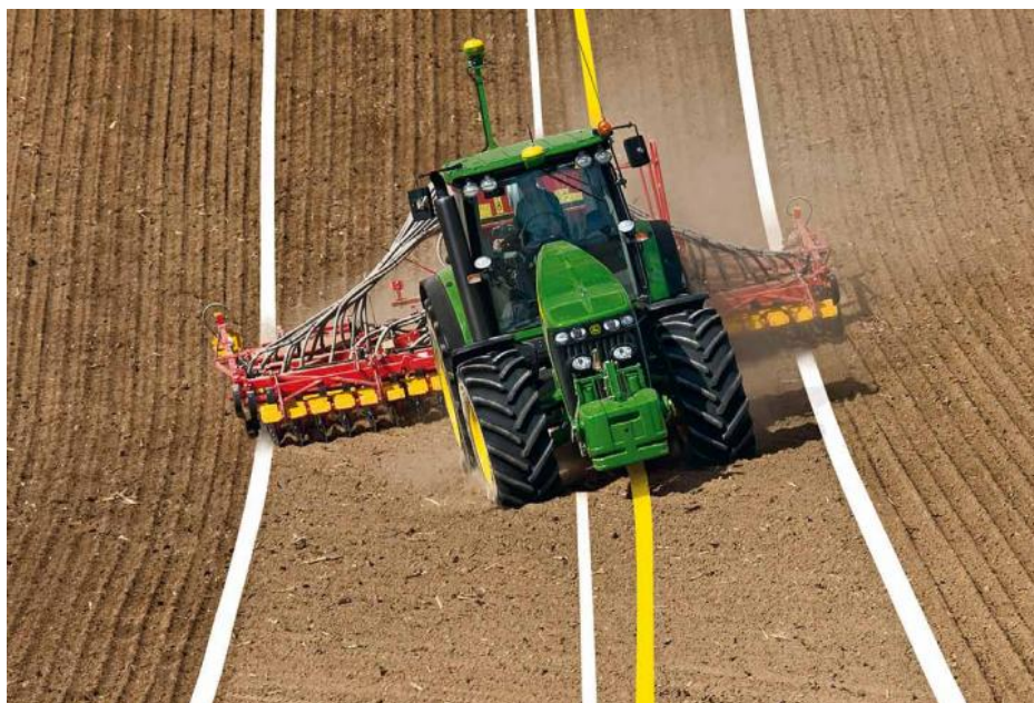
Slika 2.23. Prikaz vođenja agregata na nagnutom terenu
