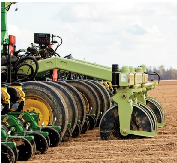
Slika 2.24. Dodatna oprema za korigovanje položaja priključnih mašina
