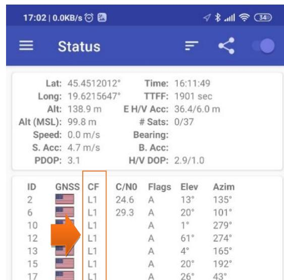
Slika 2.15. Slika ekrana mobilnog telefona sa aplikacijom GPSTest i prikazom osnovnih informacija o *GPS* vezi. Crveno polje označava vrste signala koje telefon prima. U konkretnom slučaju radi se o
