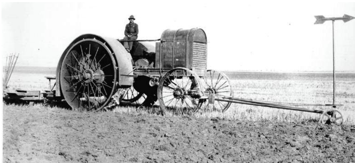
Slika 2.16 Prvi traktor sa automatskim vođenjem u operaciji obrade zemljišta ( Heraud i Landge, 2009 )
