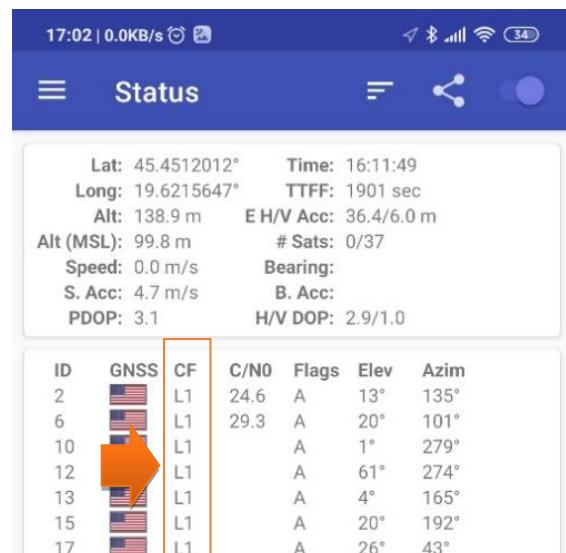
Slika 1.15. Slika ekrana mobilnog telefona sa aplikacijom GPSTest i prikazom osnovnih informacija o GPS vezi. Crveno polje označava vrste signala koje telefon prima. U konkretnom slučaju radi se o
